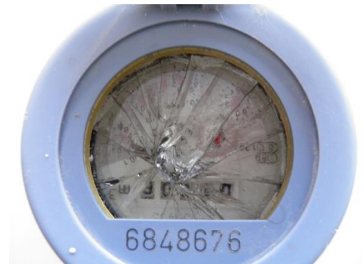
Das Glas ist beschädigt – deutlicher Hinweis auf einen Frostschaden des Wasserzählers
